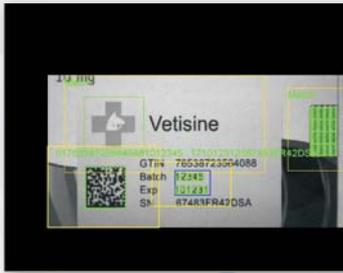
Kontrolle der Ausrichtung von Etiketten, einschließlich der Strichcodeprüfung und der visuellen Lesbarkeit des Texts
