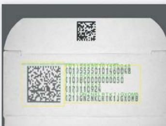
Track & Trace-Applikation mit Prüfung der GS1-Data Matrix und visuell lesbarer Textkonsistenz (gleicher Dateninhalt), mit zusätzlicher Data Matrix-Qualitätskontrolle gemäß ISO 15415
